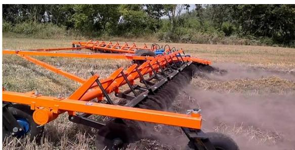
Луцильник предназначен для обработки почвы и лушения стерни после уборки зерновых культур, а также для обработки почвы после вспашки в качестве односледной дисковой бороны при разделке пластов и измельчений глыб.
