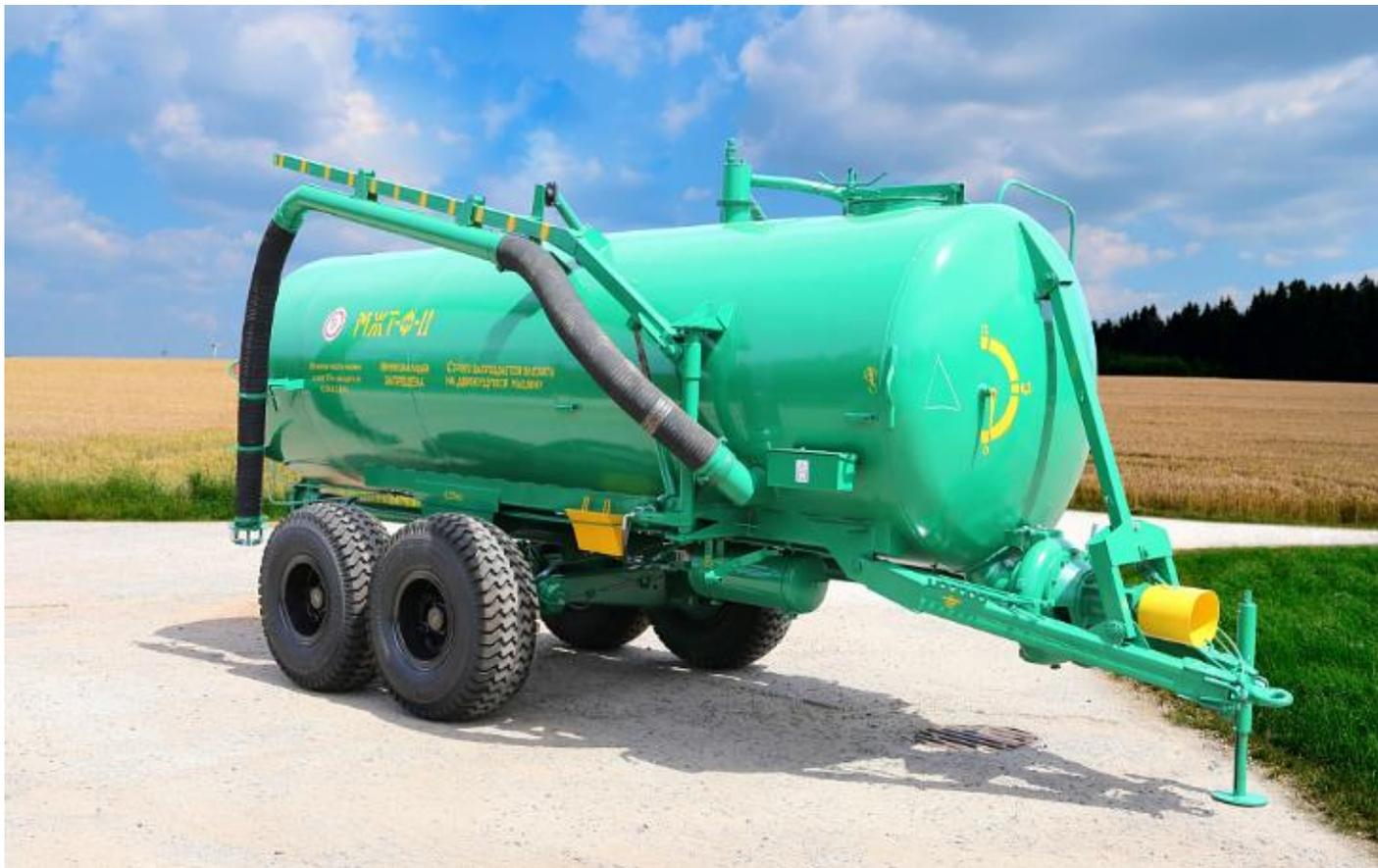
Машина для внесения жидких органических удобрений МЖТ-Ф-11 предназначена для самозагрузки, транспортирования, перемешивания и сплошного поверхностного распределения жидких органических удобрений, а также для перевозки технической воды и мойки машин, при пожаротушении, мойки дорог и т.д.
